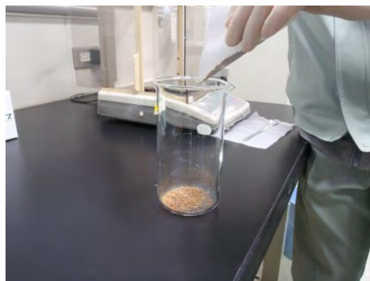
図3 試料の量り取り操作
