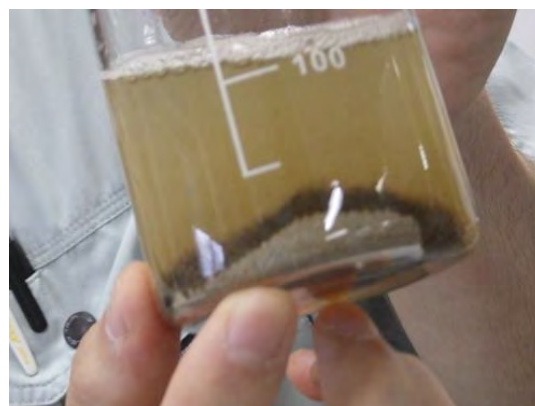
図5 アルカリ処理の溶液添加後
