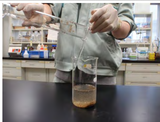
図4 アルカリ又は酸溶液の添加操作
