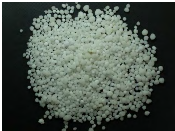
▲ 硝酸石灰(1), 現物 吸湿性が非常に強い.
