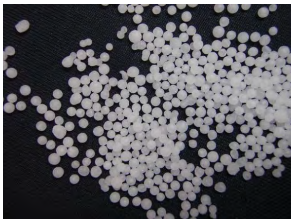
▲ 尿素(1), 現物 白色無臭の結晶で水に溶けやすく吸湿性が高い。
