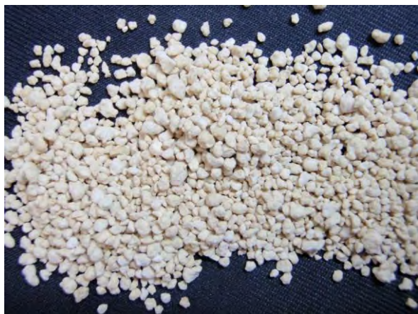
▲ アセトアルデヒド加工尿素肥料(1), 現物 白色結晶性で吸湿性が低く水への溶解度も低い。
