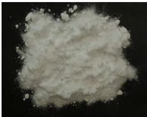
▲ 硝酸アンモニア(1), 現物 白色の粉末で吸湿・固結しやすい。
