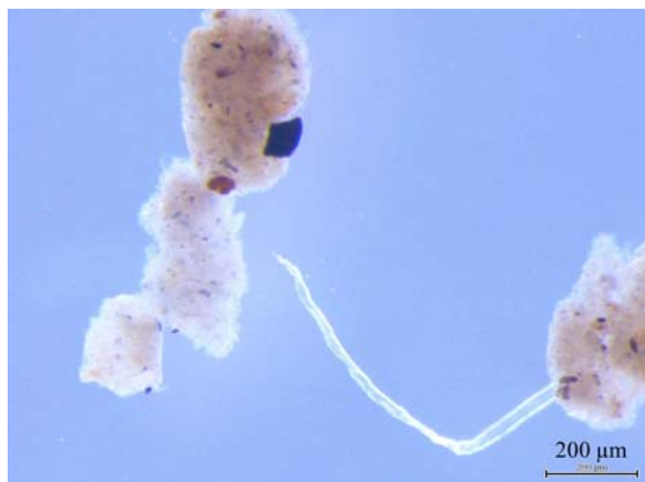
▲ 混合汚泥肥料(1):原料は下水汚泥肥料 45% + し尿汚泥肥料 40% + 植物質残さ 15%, 実体顕微鏡(アルカリ処理, 214倍)
