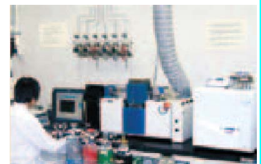
安定同位体比測定装置
