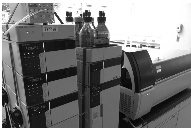
麦類のかび毒の分析 (試料粉碎・採取、カラム精製、LC-MS/MSによる測定)
