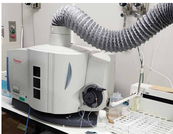
図3 ICP-OES: 元素固有の光の強さから元素量を測定
