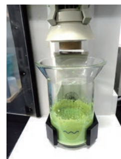
試料の粉碎 セラミック製の刃を使用
