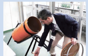
種子に農薬をコーティングするために使用する種子粉衣機
