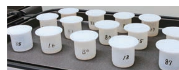
試料の酸分解 酸を加え、ホットプレートで加熱
