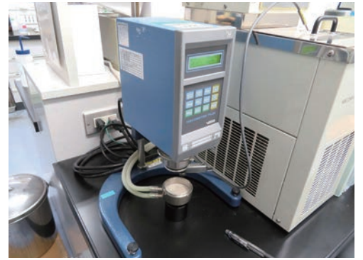
液体の粘り気を測定する粘度計
