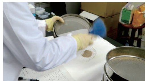
農薬製剤の粒度分布 (粒の大きさの分布)の検査
