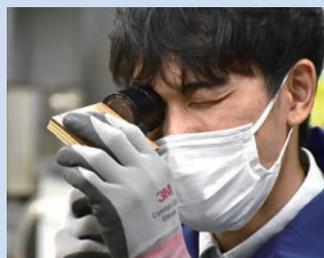
乾燥が終わったらフローリングの側面を見て、材料同士が剥がれていないかを確認します。
