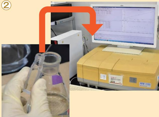
ホルムアルデヒドを吸収した蒸留水に試薬を加えて発色させ、分光光度計で測定します。その吸光度から、ホルムアルデヒドの放散量を算出します。
