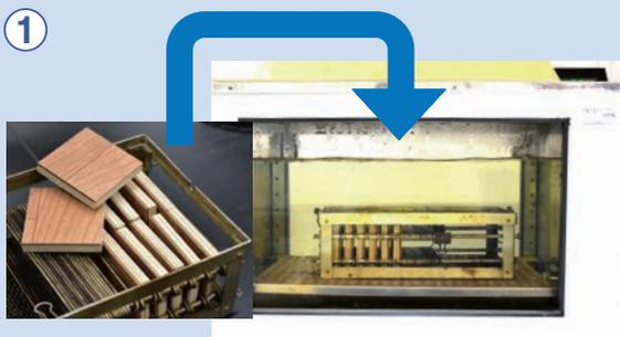
フローリングの試験片を、70℃に設定したお湯に2時間沈めます。
