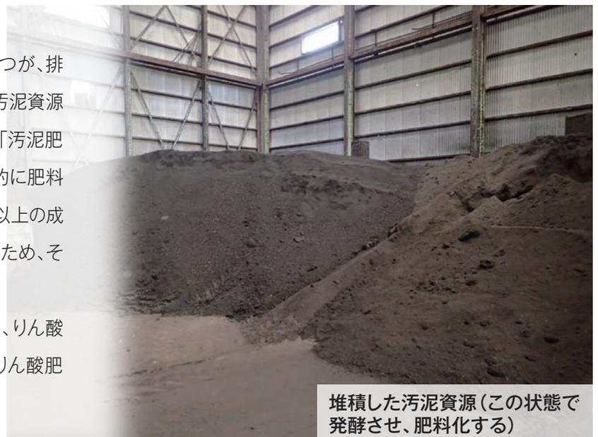
堆積した汚泥資源（この状態で発酵させ、肥料化する）
